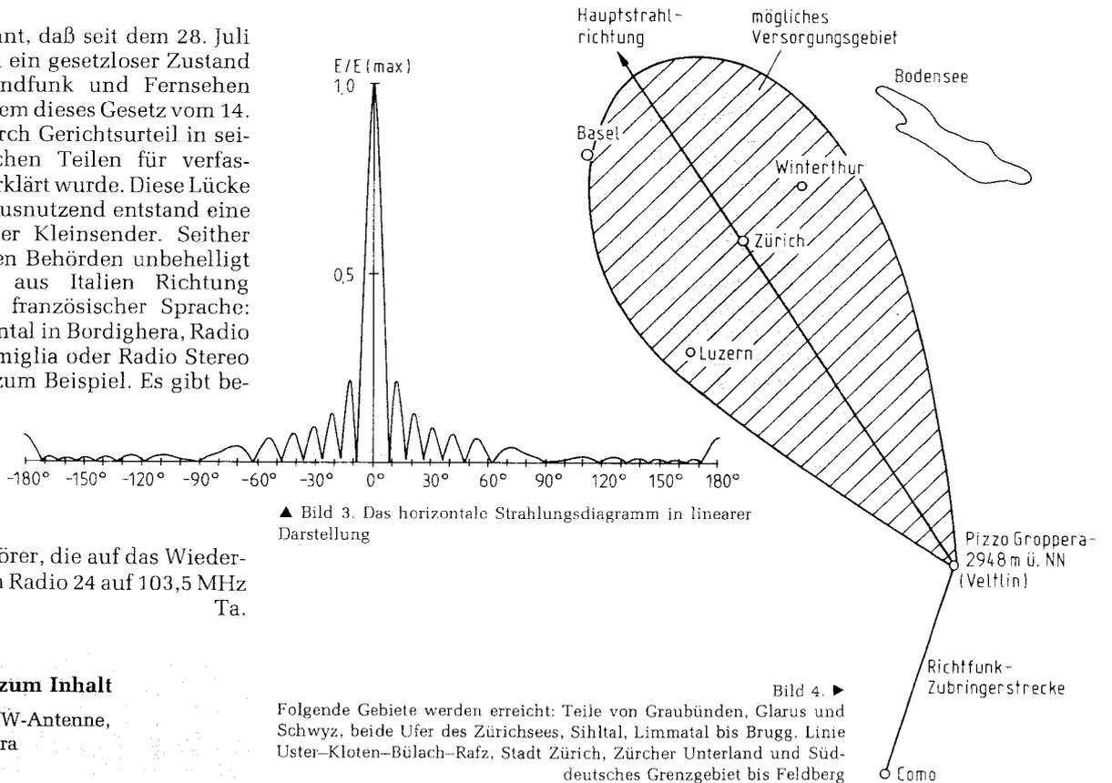
▲ Bild 3. Das horizontale Strahlungsdiagramm in linearer Darstellung
